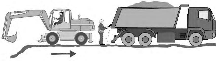
Abb. 2 Gefährdung durch Rückwärtsfahren des Baggers
